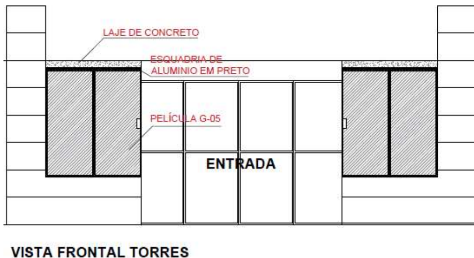
Figura 3 – Modelo de esquadrias com vidro temperado e película escura em torres
